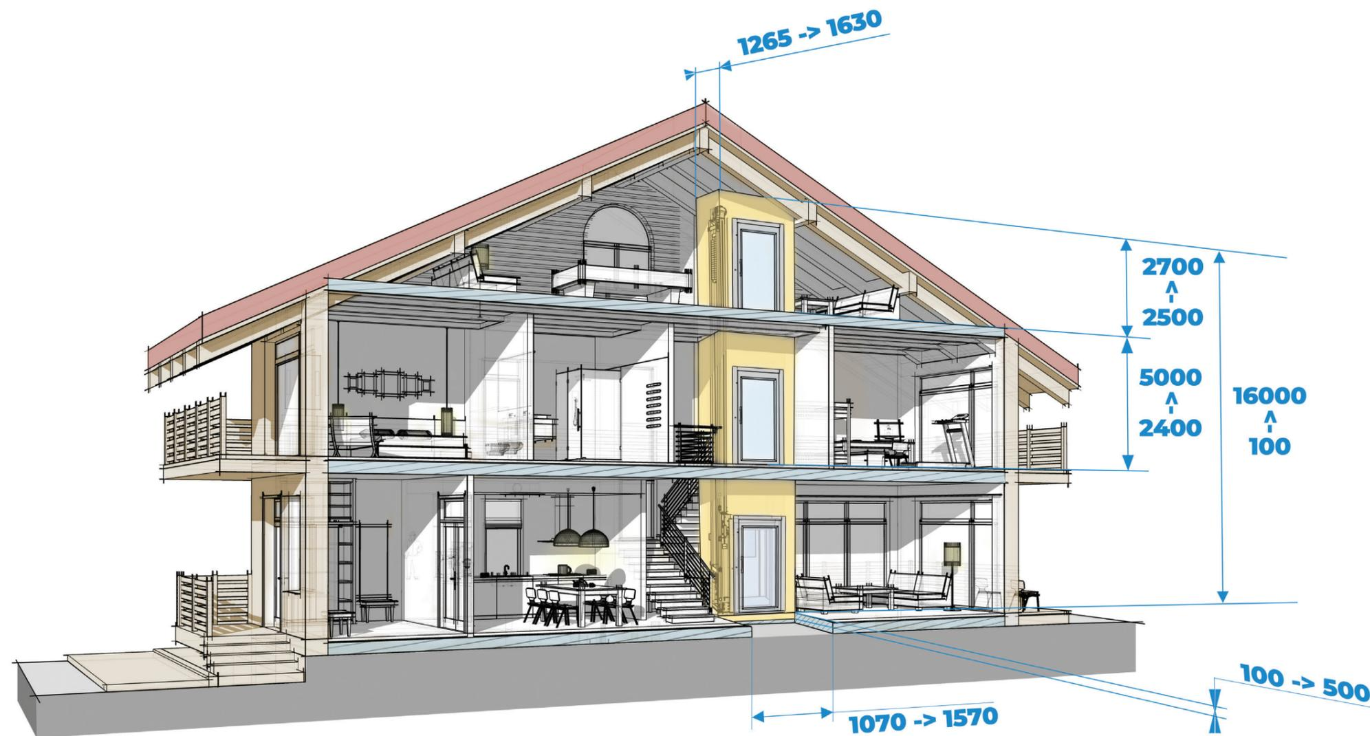
\*les dimensions (en mm) sont à titre indicatif, à affiner en fonction du choix des portes, du positionnement de l'ensemble mécanique et de la solution pylône ou gaine maçonnée.
